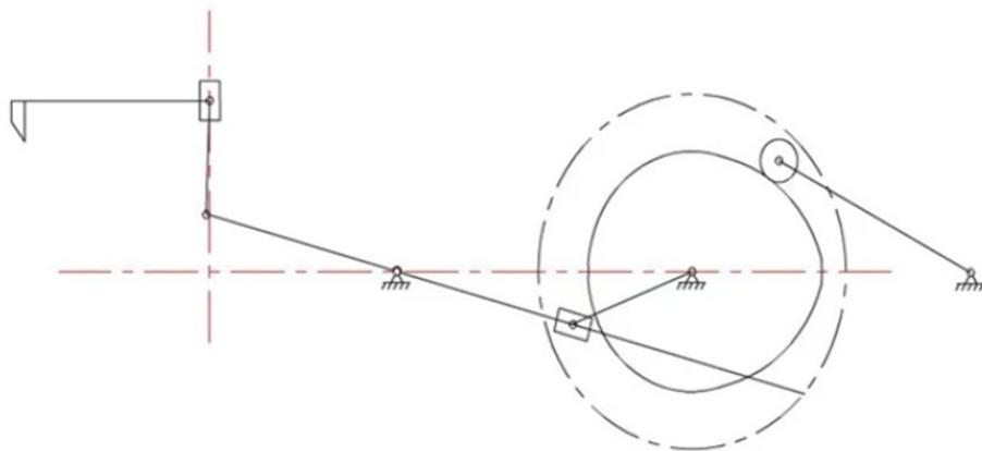
该机构是由曲柄滑块及导杆机构和凸轮机构构成,曲柄滑块和导杆机构决定了行程速比系数K并且使本机构具有急回运动的性质满足设计要求。而且关键的
