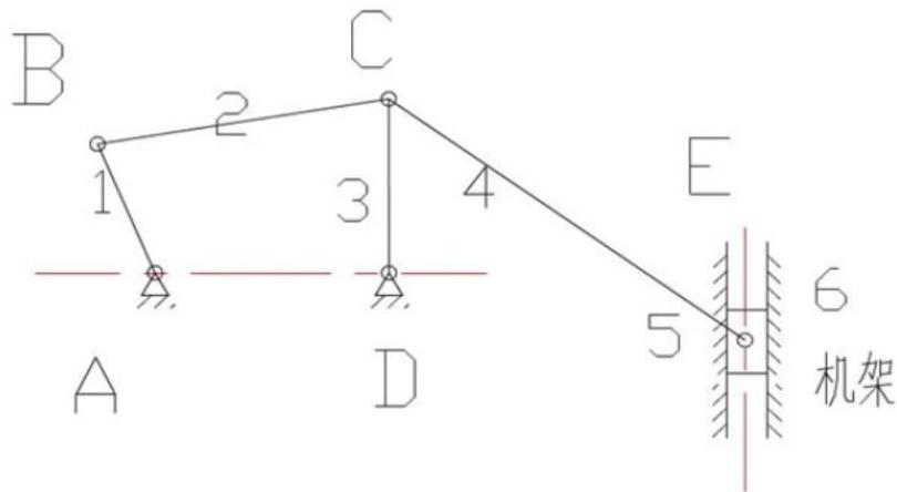
该方案的机构,对于这个机构我们要分析比较才能进行选择。因为左边这个四杆机构各个杆的杆长不同就会导致不同的机构出现,进而影响到右边的曲柄滑块机构,最后会导致插刀的运动不合要求。
