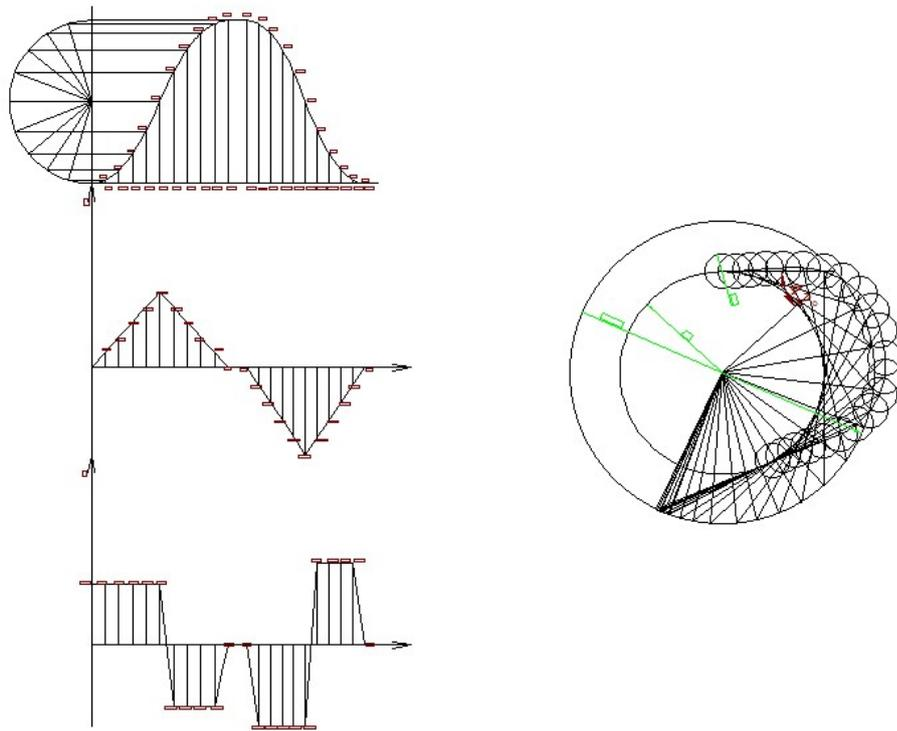
图 4-2 从动件运动曲线  $s-\delta$  / 图 4-3 凸轮廓线
