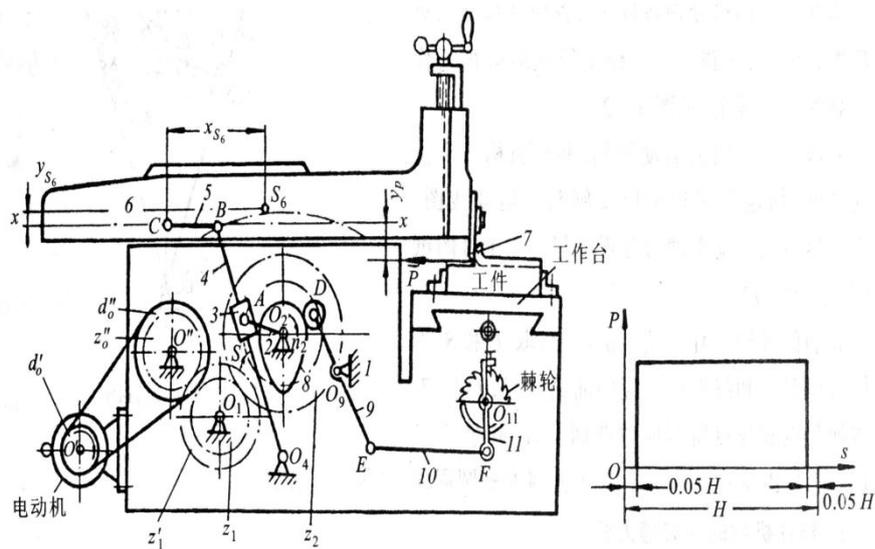
图 1-1 牛头刨床工作原理图
