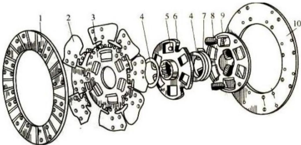
图 5-1 带扭转减振器的从动盘分解图
