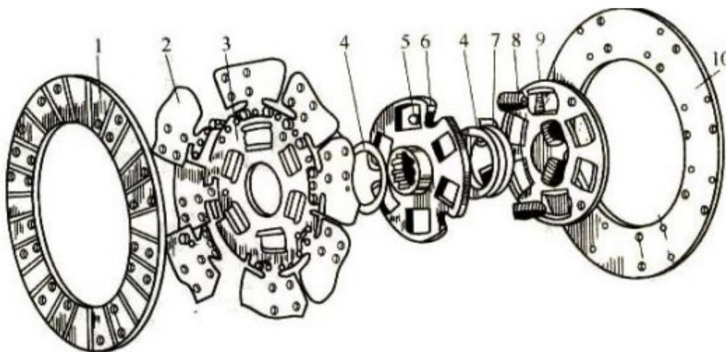
图 5-1 带扭转减振器的从动盘分解图
