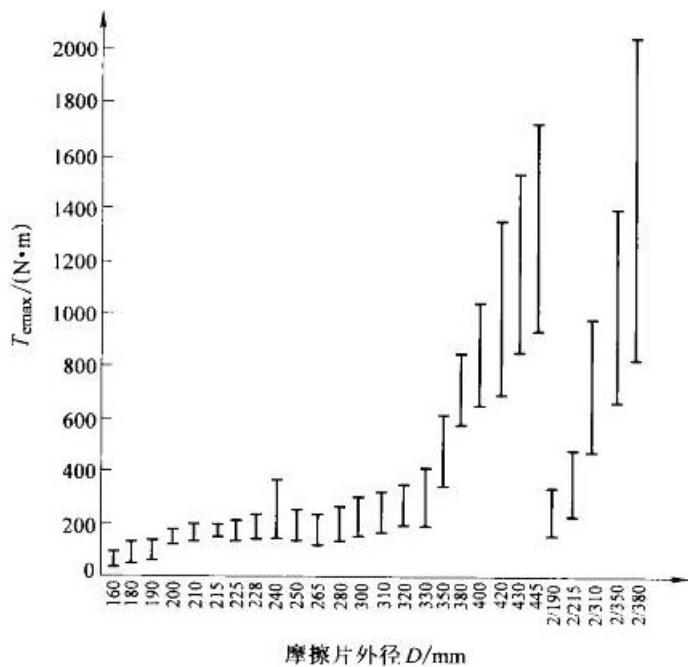
图 3-1 发动机转矩与摩擦片外径的关系
