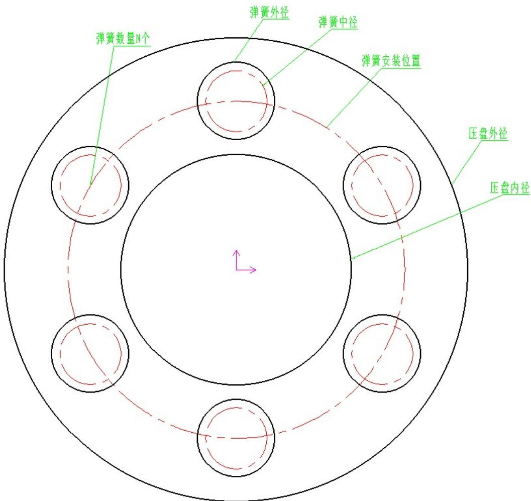
图 4-1 弹簧外径估算用简图
