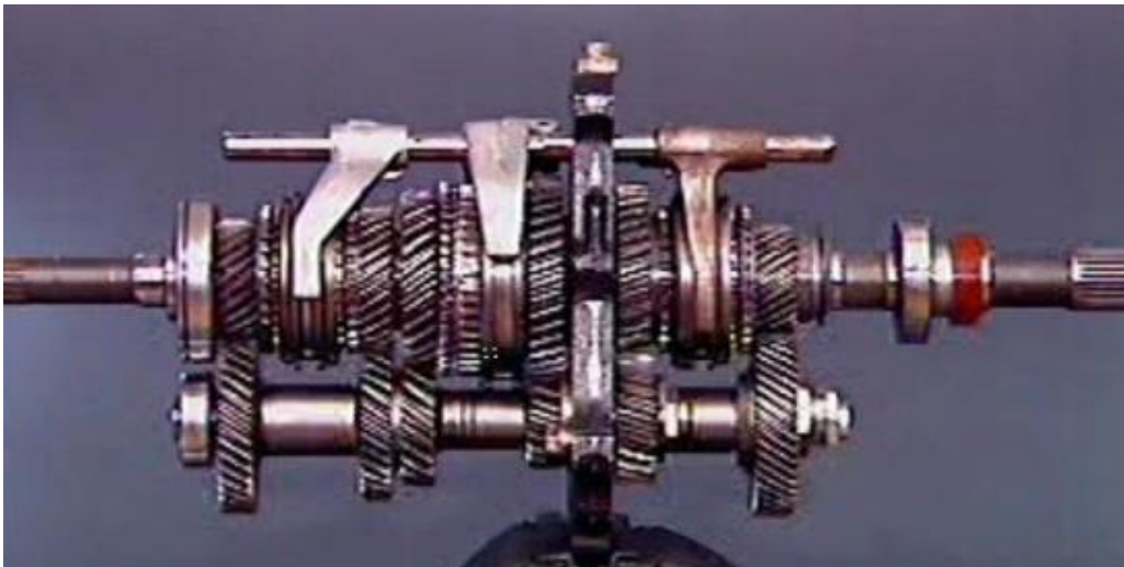
图 2-1 中间轴式变速器
